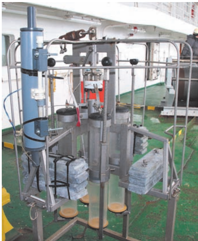
Рис. 9.1.2. Мультикорер КУМ с закрепленным на нем батометром для отбора наддонного слоя воды (на палубе НИС «АМК» перед началом работ)
